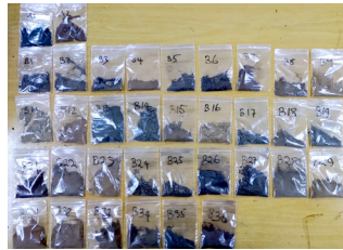
Figure 5 (左) 土壌サンプリングの様子。スコップで表層の土壌を採取しオートクレープバッグに100gほど入れている
